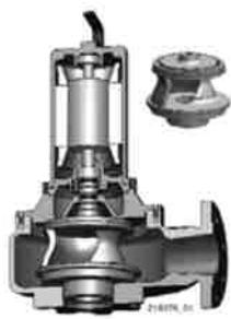
Das geschlossene, halbaxiale Kanalrad erreicht durch seine Bauform einen hohen Wirkungsgrad. Dadurch ist es ideal bei grossen Fördermengen, Medien mit Feststoffanteilen, Regen-, Kühl- oder Brauchwasser sowie für Anwendungen mit langen Laufzeiten.
