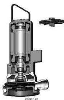
Ein Mehrkanalrad mit vor-gelagertem Zerkleinerungssystem zermahlt zuverlässig alle schneidbaren Feststoffe. Abwasser-entsorgung mit geringem Rohrleitungsdurchmesser (ab 1½"), grossen Förderhöhen bei relativ geringer Fördermenge, Druck-entwässerung in topographisch schwierigen Gebieten sind typische Einsatzgebiete. Ungeeignet ist dieses System für sandhaltige Medien.
